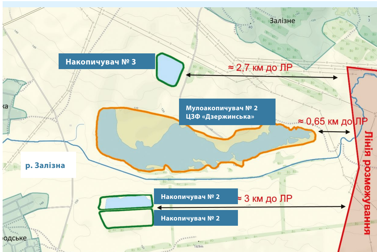
Рисунок 12. Розташування хвостосховищ НВО «ІНКОР І Ко» та інших об'єктів по відношенню до лінії розмежування
